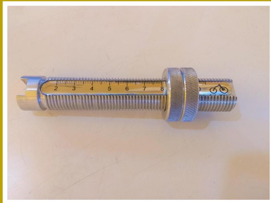
Ferramenta para posicionamento do IFP (Internal Floating Piston) – para FOX e Rock Shox.
