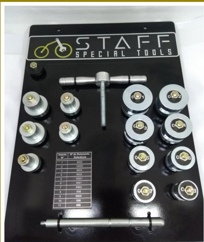
Ferramentas para desmontar e montar rolamentos de link's e balanço.
