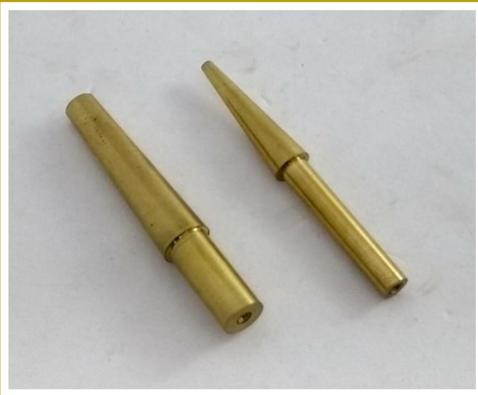
Ferramenta para montagem de anéis oring's para cartuchos das suspensões FOX.
