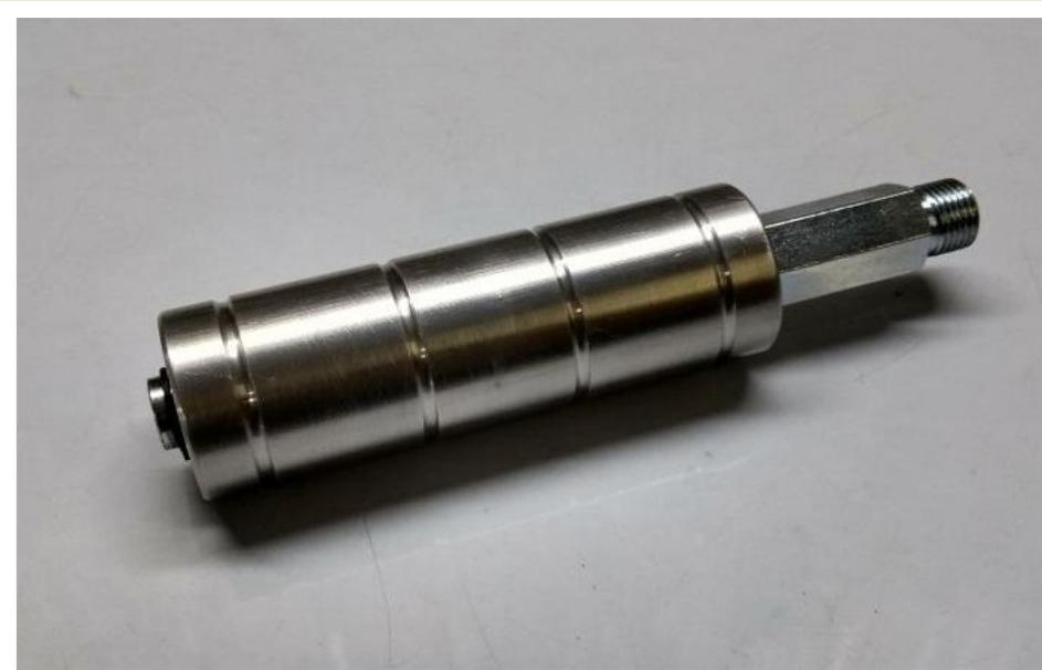
Ferramenta para simular pedal durante as manutenções.
