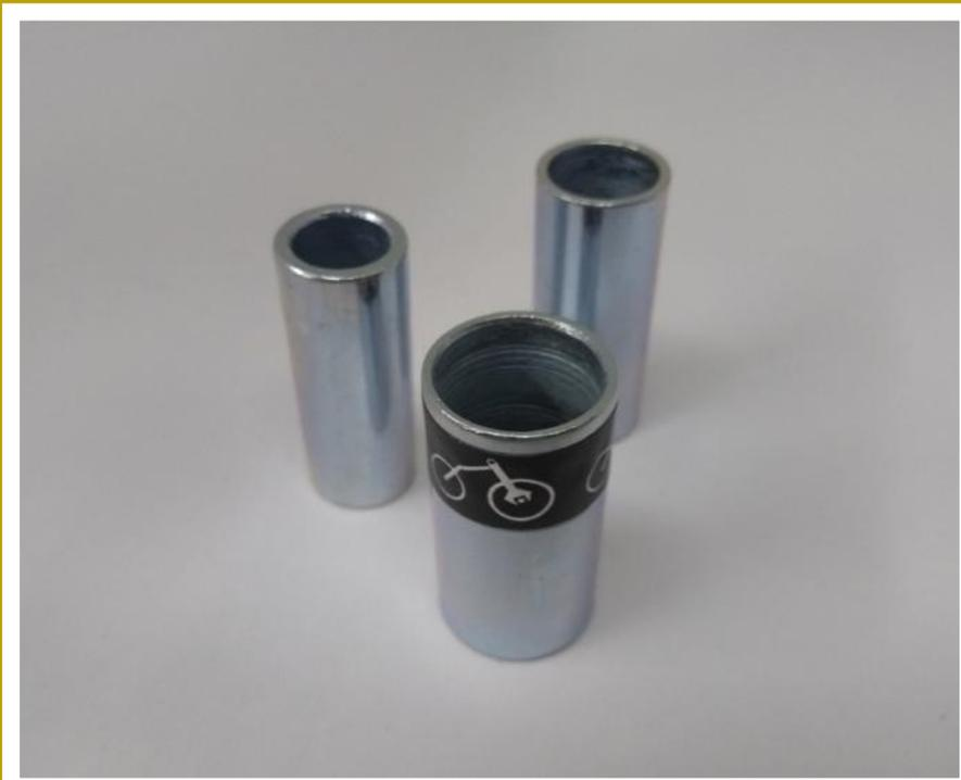
Ferramenta para montagem dos rolamentos das rodas VZan (para eixos de 10mm, 12mm, 15mm).
