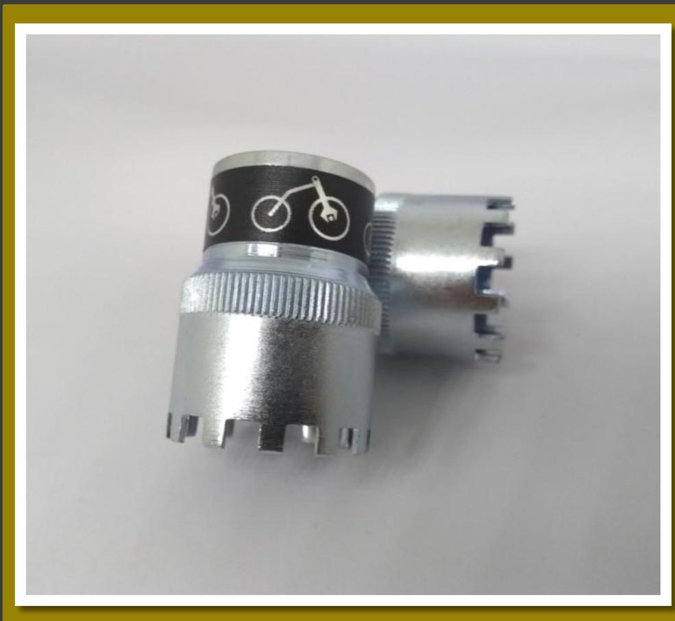
Ferramenta para desmontar e montar tampa da suspensão SR Suntour.
