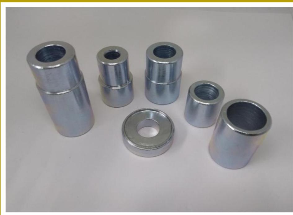
Ferramenta para montagem dos rolamentos das rodas DT Swiss (para eixos de 10mm, 15mm, 20mm e seal driver).
