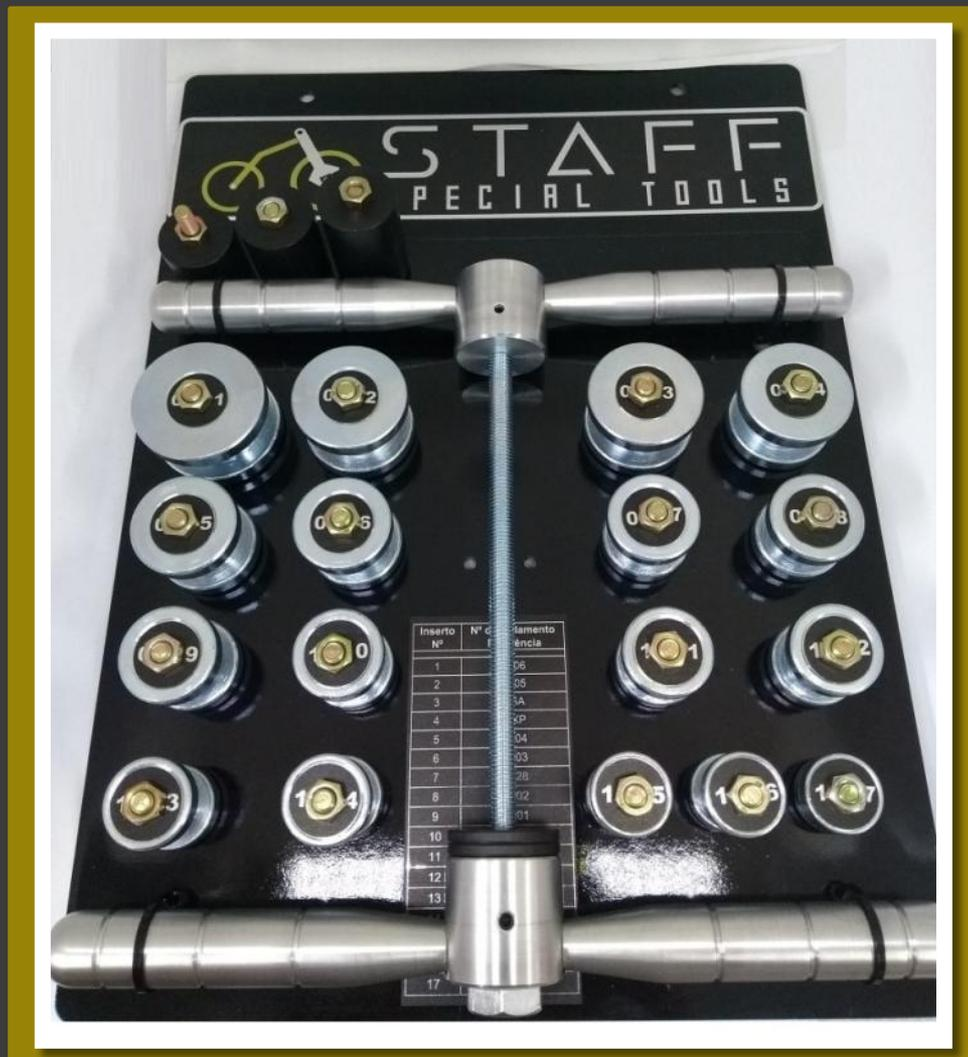
Ferramentas para montagem de rolamentos de roda/centrais/link's e balanças.
