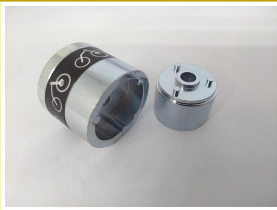
Ferramenta para montar e desmontar cartucho FIT4 suspensões FOX.
